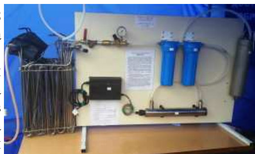
Комплексна система подачі, охолодження, фільтрації та газування напоїв, виконана учнями ДНЗ "Одеський центр професійно-технічної освіти"
