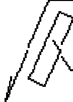
Рисунок 9. Позначення контрольного комплексу або категорії контролю шва
