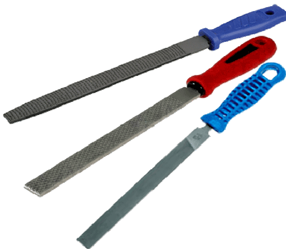
Рис. 4. Рашпилі – призначення, будова – 3 типи
